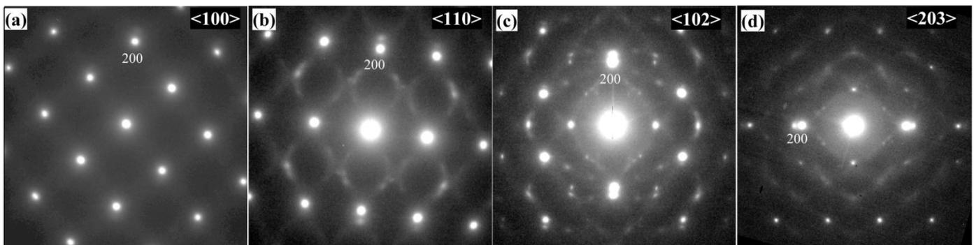
Fig. 1. SADP recorded in (a)  $\langle 100 \rangle_{\beta}$ , (b)  $\langle 110 \rangle_{\beta}$ , (c)  $\langle 102 \rangle_{\beta}$  and (d)  $\langle 203 \rangle_{\beta}$  zone axes.
